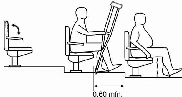
Figura 146 – Assentos para P.M.R. e P.O. – Vista lateral
