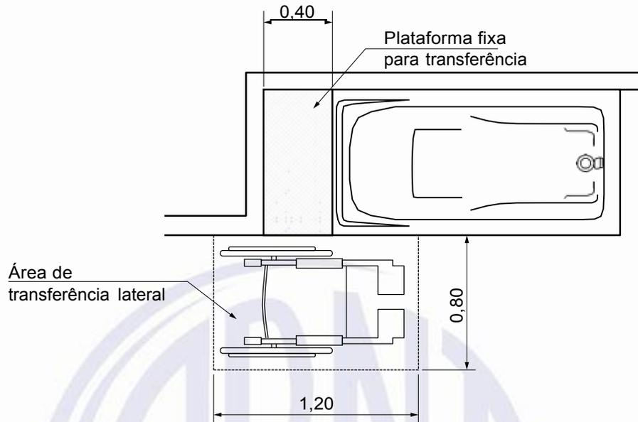
Figura 128 – Área de transferência para banheira – Plataforma fixa
