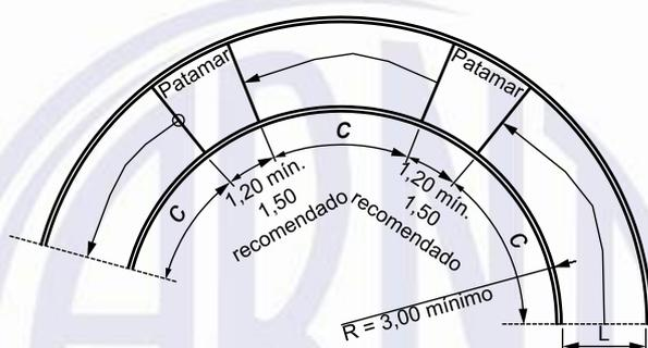
Figura 71 – Rampa em curva – Planta
