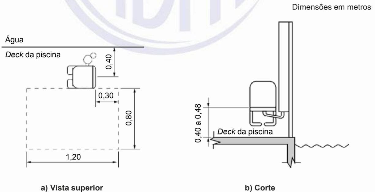
**Figura 151 – Equipamento de transferência para a piscina**
