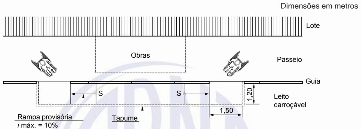
**Figura 92 – Rampas de acesso provisórias – Vista superior**
