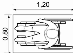
Figura 3 – Dimensões do módulo de referência (M.R.)
