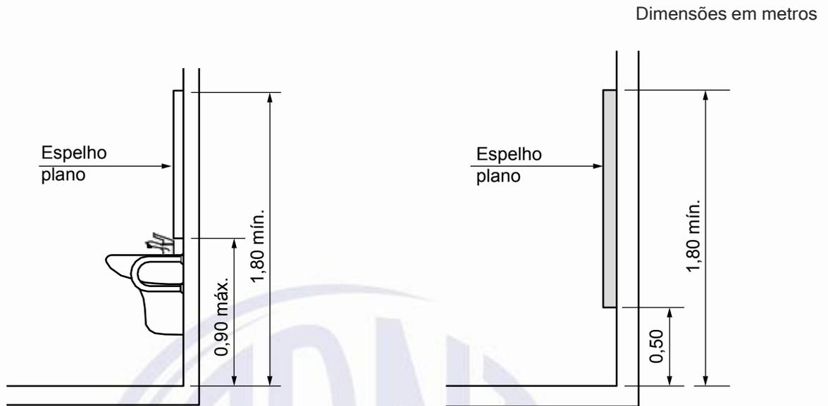
Figura 123 – Altura de instalação do espelho
