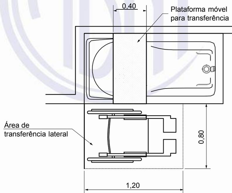
Figura 129 – Área de transferência para banheira – Plataforma móvel
